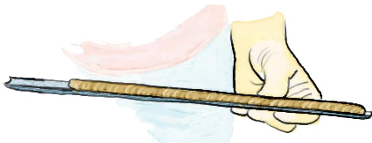
Muestra de anillos de crecimientos extraída con Barrena de Pressler
