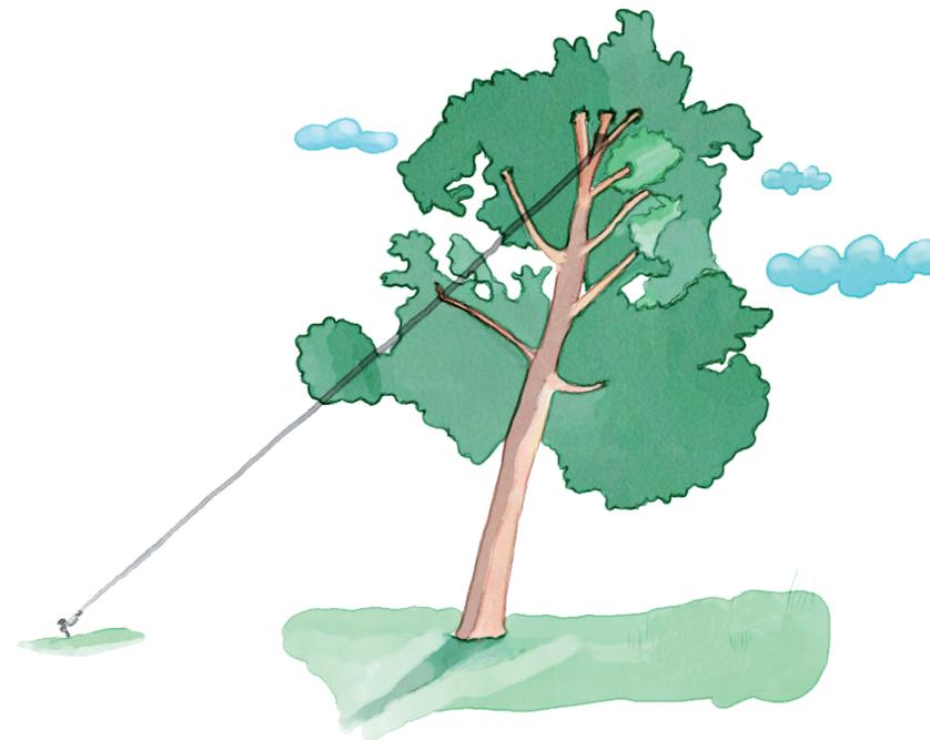
Sujección mediante soportes de árbol inclinado
